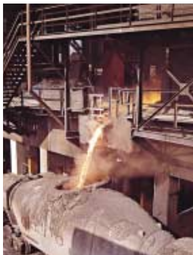
■ El hierro fundido sale del horno de la fundición a una temperatura superior a los 1.300 °C.
